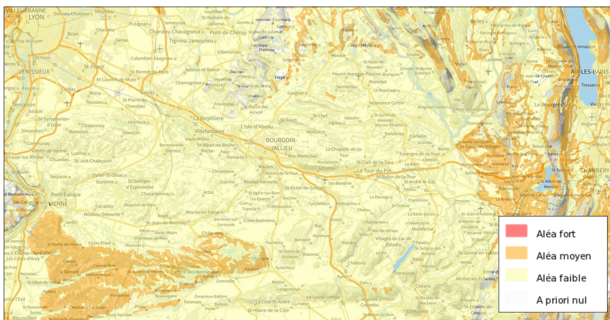
Figure V.1: Carte de l'aléa retrait-gonflement des sols argileux au niveau de la commune de Saint-Alban-de-Roche ( www.georisques.gouv.fr ).
