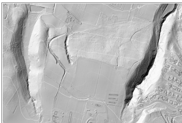
Figure 8: Extrait du MNT issu des données LiDAR HD de l'IGN sur les communes de Saint-Alban-de-Roche et Domarin.
